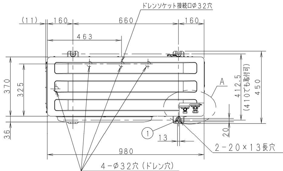
ドレンソケットを使用する場合、接続口にドレンソケットを接続し他の3か所は封止する。
