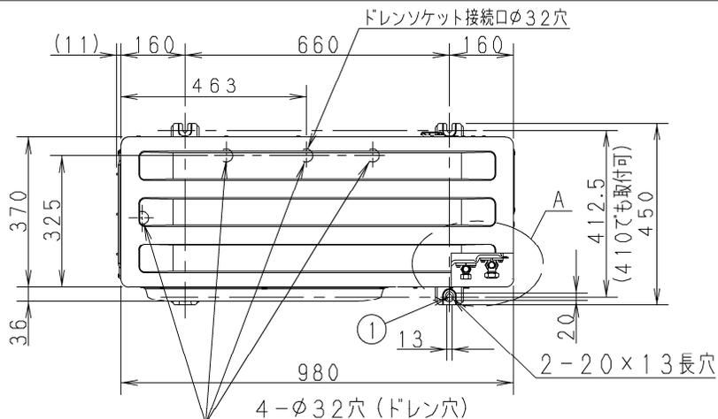
ドレンソケットを使用する場合、接続口にドレンソケットを接続し他の3か所は封止する。
